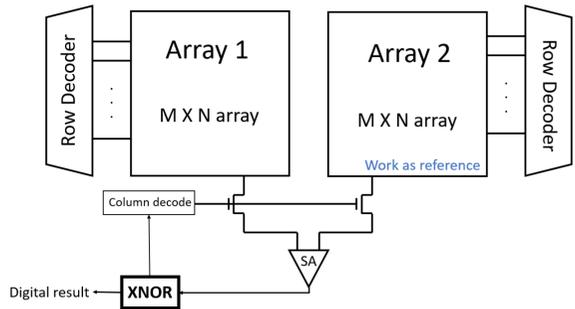
而改變Search Line電壓是為了調整0還有1的分布，上圖中XNOR邏輯閘上方有一條回溯到Search Line的電路，因為經過XNOR之後，可以知道哪些為unstable bit，所以假如出來的結果0或是1的分布不均(0比較多或是1比較多)，那就可以控制Search Line的電壓，得到平均的0和1分布；如果可以隨機亂數輸入SL電壓(加入TRNG)，那也可以增加流經cell電流分布，也就可以增加多一點PUF bit的使用了。
